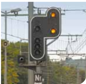
La nouvelle signalisation sera installée tous les 2,5 km au lieu de tous les 10 km aujourd'hui. De quoi améliorer les performances du réseau.
